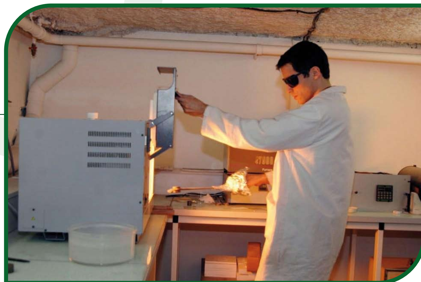
Utilisation d'un four (1500°C) pour la synthèse des verres © P. Kitmacher, UPMC
